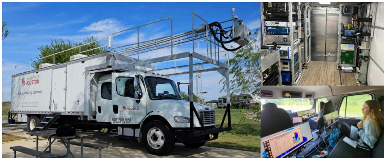
*Figura 1. Fotografías de MAQL3. La foto superior derecha muestra un ejemplo de instrumentos instalados en el espacio del laboratorio trasero y la imagen inferior derecha muestran un ejemplo de las estaciones del operador en la cabina.*
