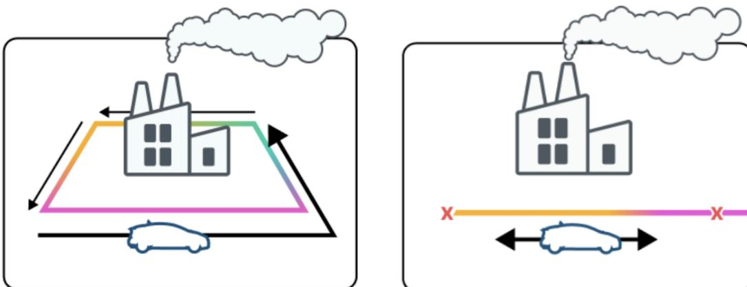
**Figura 4:** Ejemplo de técnica de medición para monitoreo de área específica utilizando (izquierda) conducción de cercas que inspecciona sistemáticamente el perímetro de una instalación o sitio de fuente conocida o sospechada y (derecha) conducción de transectos siguiendo un camino diseñado para tomar muestras a favor, en contra y a favor del viento de una columna potencial de contaminación de una fuente conocida o potencial.
